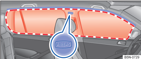
图 35 车辆左侧：头部安全气囊安装位置及作用范围
