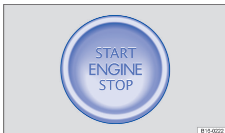
图 86 中控台下部：用于启动发动机的启动/停机按钮
