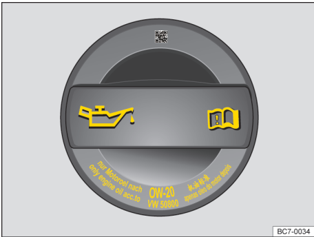
图 139 机油加注口盖上的标识(示意图)
