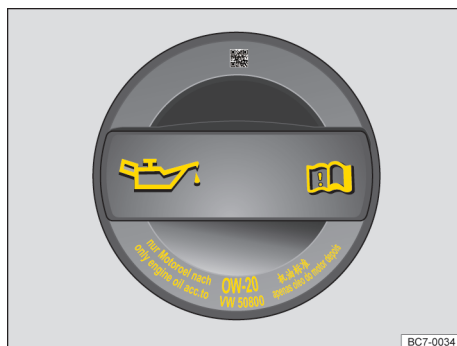
图 141 发动机舱内：发动机机油加注口的盖子（示意图）
