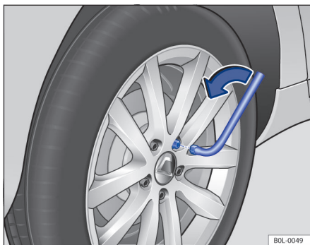
图 160 更换车轮：用车轮螺栓套筒扳手拆卸车轮螺栓
