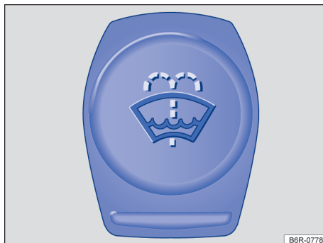
图 138 发动机舱内：车窗玻璃清洗液储液罐盖
