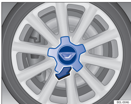
图 154 拔下车轮中心盖板
