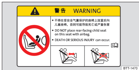
图 37 遮阳板上的安全气囊标签
