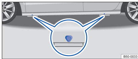
图 158 千斤顶的支撑点
