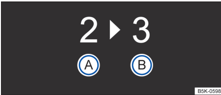
图 83 组合仪表显示屏：挡位建议（示意图）
