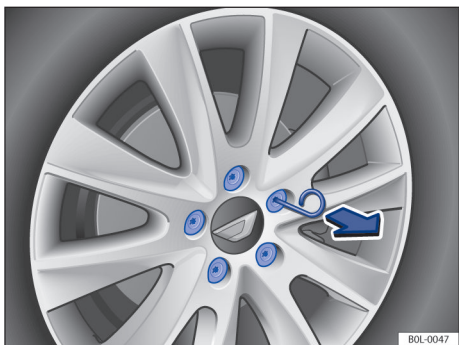
图 155 从车轮螺栓中拔出防护帽（示意图）
