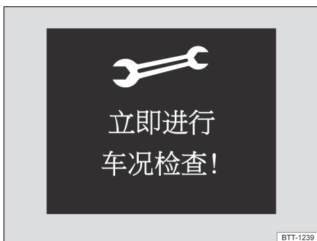
图 18 在组合仪表的显示屏中：某个保养项目到期时的显示示例（示意图）
