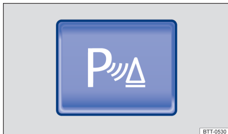
图 102 中控台上部：用于开启或关闭泊车雷达警告音的按钮(示意图)
