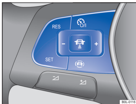
图 98 多功能方向盘左侧：ACC 的操作按钮
