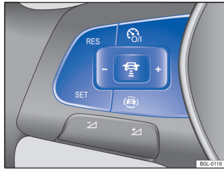
图 95 多功能方向盘左侧：车速限制器的操作按钮
