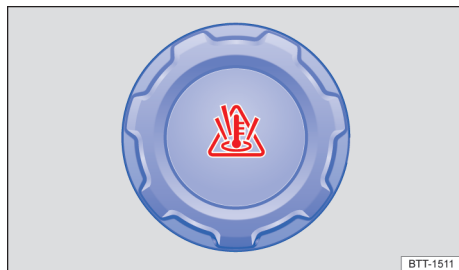
图 143 发动机舱内：发动机冷却液储液罐的盖子（原理图）
