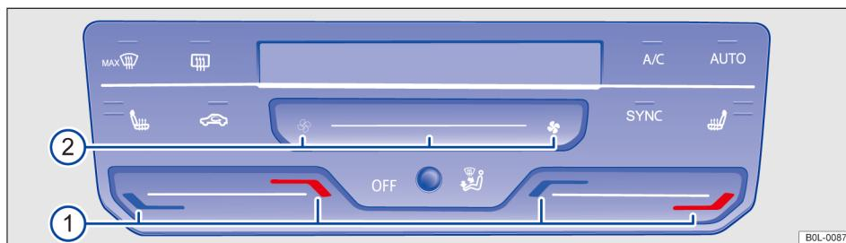
图 79 中控台上部：全自动空调系统操作机构
