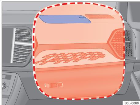
图 33 前排乘员正面安全气囊安装位置及作用范围
