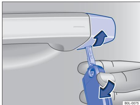
图 49 驾驶员侧车门拉手: 撬起盖罩
