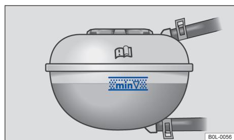
图 142 发动机舱内：发动机冷却液膨胀罐的标记（示意图）
