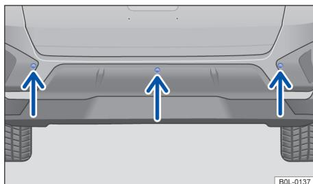
图 101 后保险杠上：后部泊车雷达系统超声波传感器
