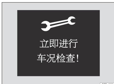
图 19 在组合仪表的显示屏中：某个保养项目到期时的显示示例（示意图）
