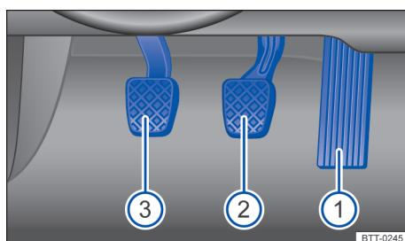
图 80 脚部空间内：手动变速箱车型的踏板
