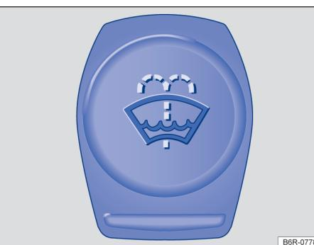
图 138 发动机舱内: 车窗玻璃清洗液储液罐盖
