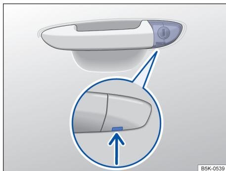
图 48 驾驶员侧车门拉手: 隐蔽式车门锁芯
