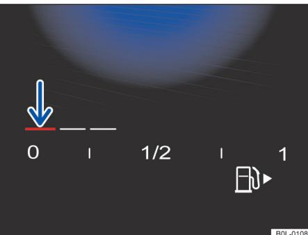
图 16 数字组合仪表（基本型）中的燃油油量表
