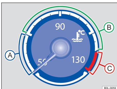
图 17 模拟组合仪表中的发动机冷却液温度表
