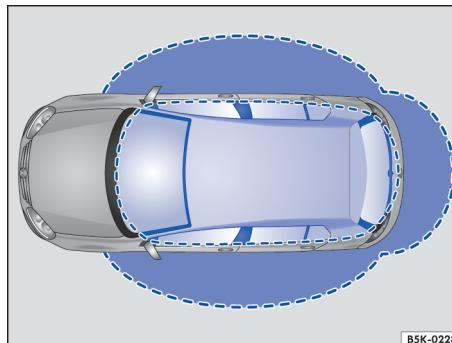
图 45 Keyless Access 闭锁/启动系统：接近范围
