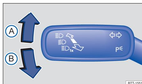
图 69 转向柱左侧：转向信号灯/前照灯远光操纵杆
