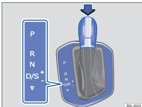
图 89 带锁止按钮（箭头）的自动变速箱变速杆
