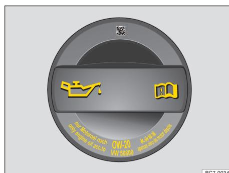
图 139 机油加注口盖上的标识(示意图)
