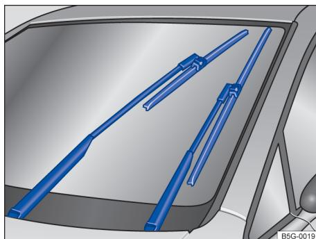
图 123 风窗玻璃刮水器在维护位置
