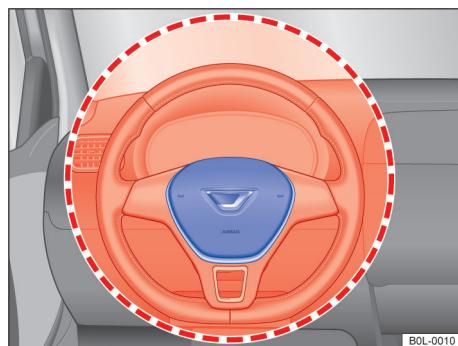
图 32 驾驶员正面安全气囊安装位置及作用范围
