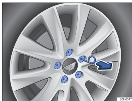
图 155 从车轮螺栓中拔出防护帽（示意图）
