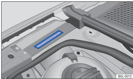
图 165 发动机舱内：车辆识别代号（示意图）
