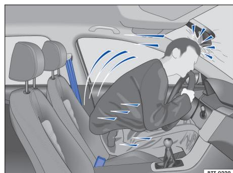
图 25 碰撞时未系安全带的驾驶员被猛力抛向前方 ▶
