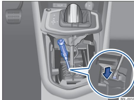
图 92 手动开启变速杆锁
