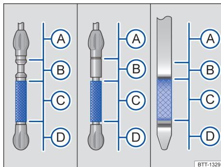
图 140 带机油油位标记的机油标尺（示例）
