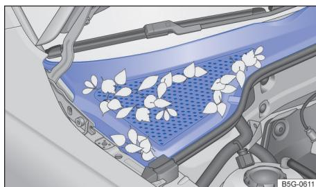
图 161 发动机舱和风窗玻璃之间：排水槽（示意图）
