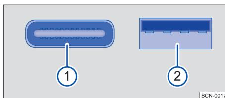
图 115 USB 供电接口（示意图）
