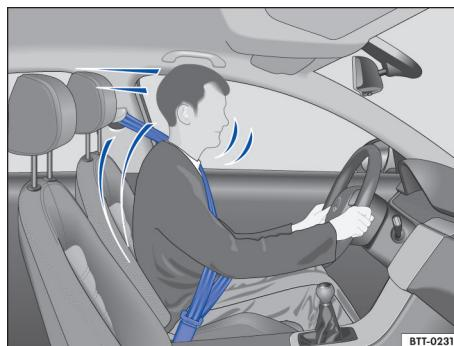
图 27 紧急制动时正确佩戴安全带的驾驶员可获有效保护
