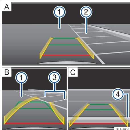
图 104 信息娱乐系统的屏幕显示: 利用后视影像系统泊车
