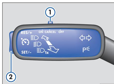
图 93 转向柱左侧：操作 GRA 的开关和按钮
