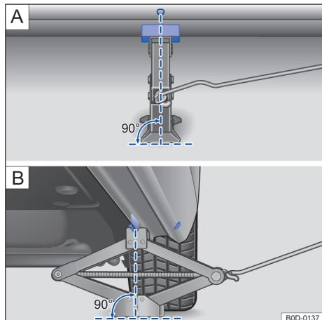
图 159 千斤顶放置在车辆左侧后部
