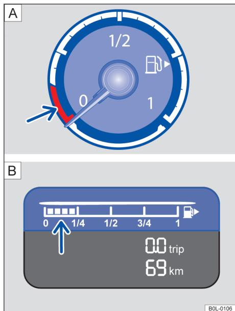
图 15 模拟组合仪表中的燃油油量表：[A] 类型一；
