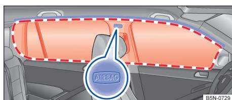
图 36 车辆左侧：头部安全气囊安装位置及作用范围
