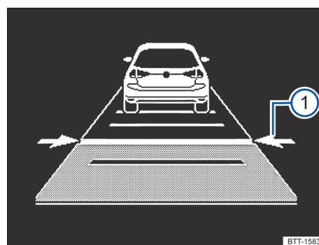
图 98 组合仪表显示屏：设置车距（示意图，ACC 调节）
