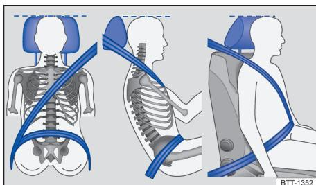
图 30 安全带和头枕的正确调整位置
