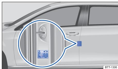
图 151 驾驶员侧车门柱上：胎压标牌
