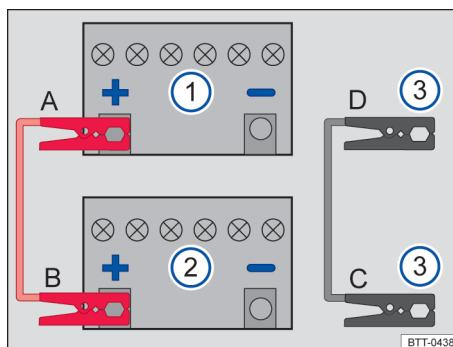
图 130 连接起动辅助电缆的示意图
