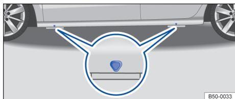
图 158 千斤顶的支撑点
