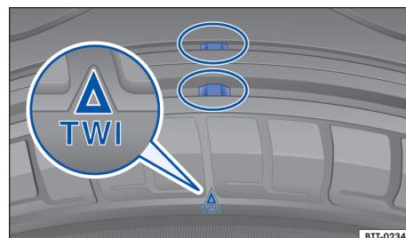
图 152 轮胎花纹：磨损标记（示意图）
