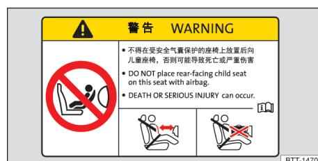
图 38 遮阳板上的安全气囊标签
