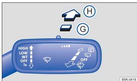
图 72 转向柱右侧: 后风窗刮水器操纵杆操作位置
