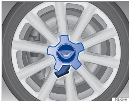
图 154 拔下车轮中心盖板
