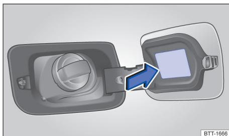
图 120 油箱盖内侧：燃油提示牌（示意图）。
