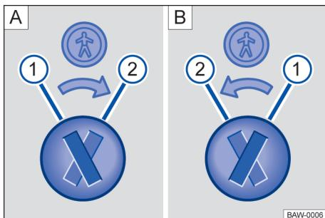
图 51 儿童安全门锁: [A] 左后车门, [B] 右后车门
