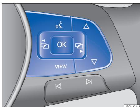
图 20 多功能方向盘右侧：用于操作组合仪表菜单和信息显示的按键（本类型仅为示例）
