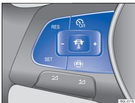
图 97 多功能方向盘左侧：ACC 的操作按钮
