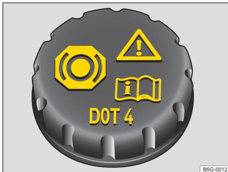
图 144 发动机舱内：制动液储液罐的盖子
