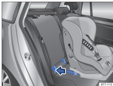
图 40 示意图：利用固定臂安装 ISOFIX 儿童座椅
