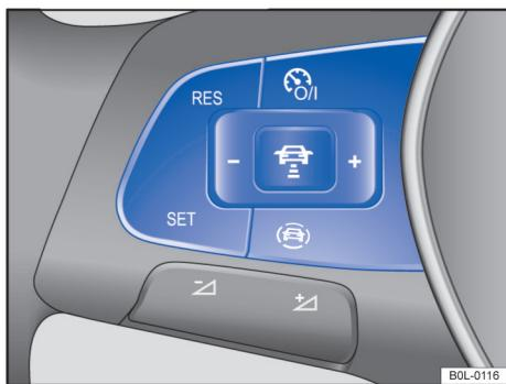
图 94 多功能方向盘左侧：车速限制器的操作按钮
