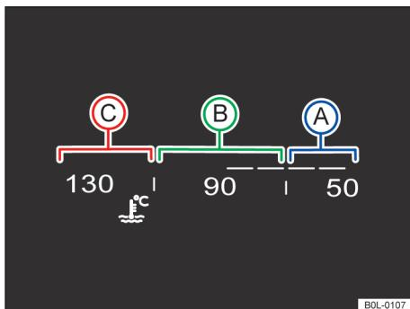
图 18 数字组合仪表（基本型）中的发动机冷却液温度表
