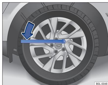
图 156 更换车轮：拧松车轮螺栓
