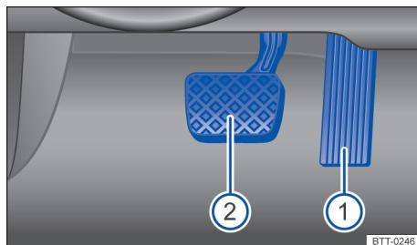
图 81 脚部空间内：自动变速箱车型的踏板
