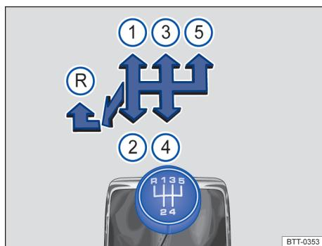
图 88 5 挡手动变速箱的挡位示意图
