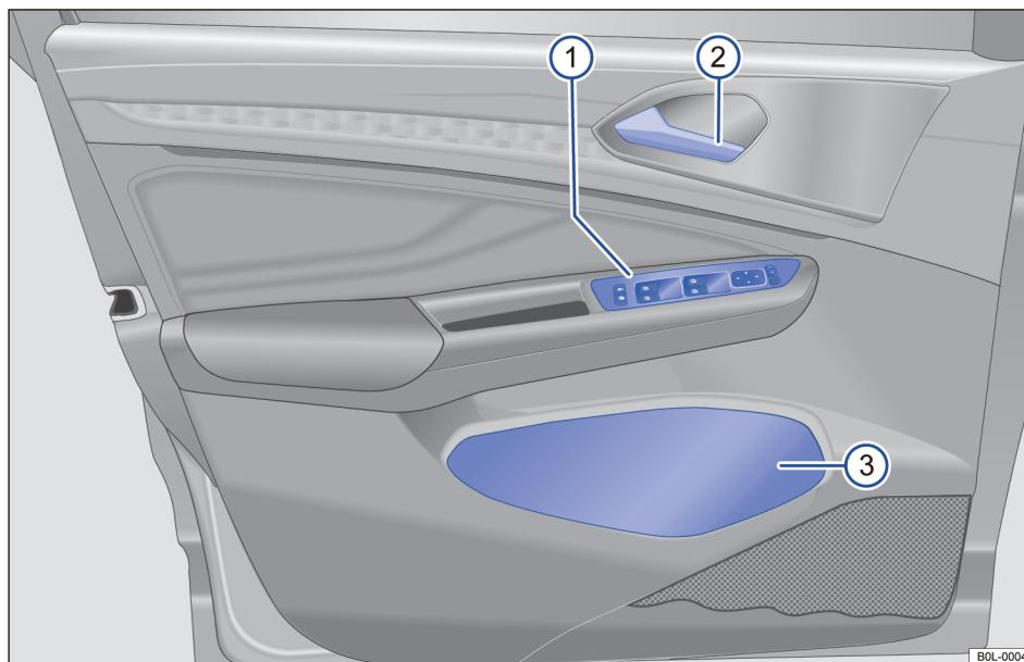
图 6 驾驶员侧车门操作机构概貌
