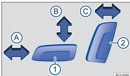
图 59 左前座椅上的调整开关：调节座椅前后位置、靠背角度及坐垫高度
