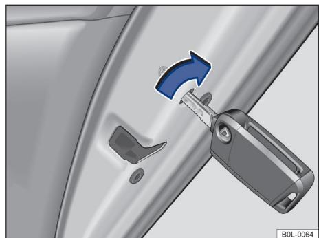
图 50 右侧车门端面: 用应急钥匙闭锁车辆
