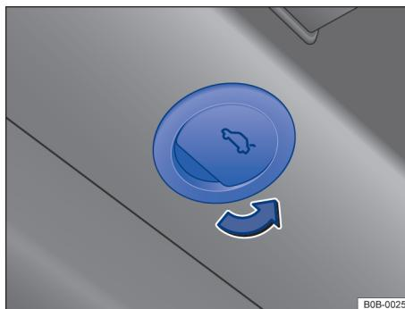
图 50 在行李箱盖中：拆下圆形盖板
