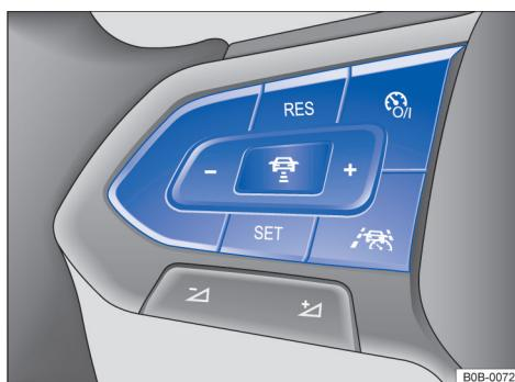
图 95 多功能方向盘左侧：操作半自动驾驶辅助系统 (Travel Assist) 的按钮
