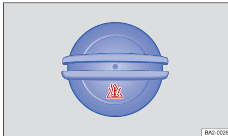
图 132 发动机舱内：发动机冷却液膨胀罐的盖子（示意图）
