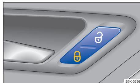
图 42 驾驶员车门内：中央门锁控制按钮
