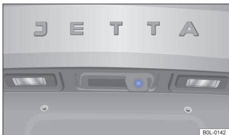
图 147 行李箱盖上：倒车摄像头（原理图）
