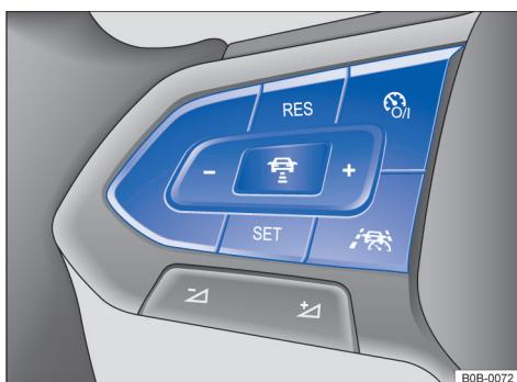
图 91 多功能方向盘左侧：ACC 的操作按钮
