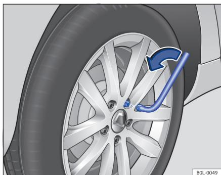
图 144 更换车轮：用车轮螺栓套筒扳手拆卸车轮螺栓
