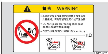
图 33 遮阳板上的安全气囊标签
