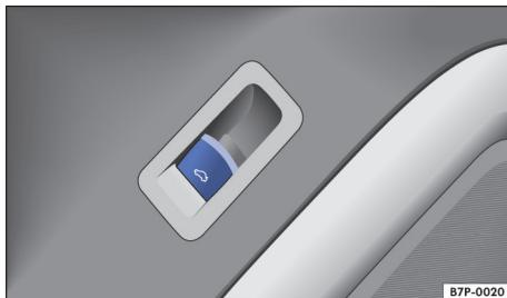
图 49 驾驶员车门内：行李箱盖的解锁机构
