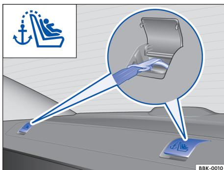
图 36 后窗台板上用于连接顶部固定带的固定环
