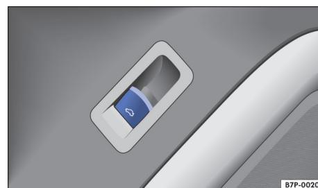
图 43 驾驶员车门内：行李箱盖的解锁机构
