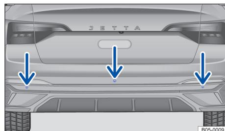
图 98 后保险杠上：后泊车雷达系统超声波传感器
