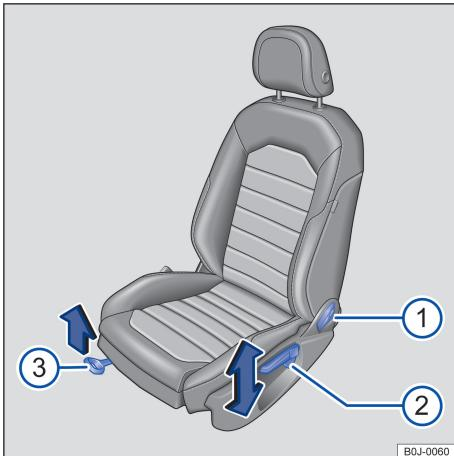
图 58 左前座椅上的：操作元件
