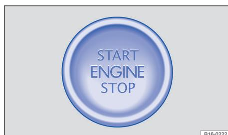
图 82 中控台下部：用于起动发动机的起动/停机按钮
